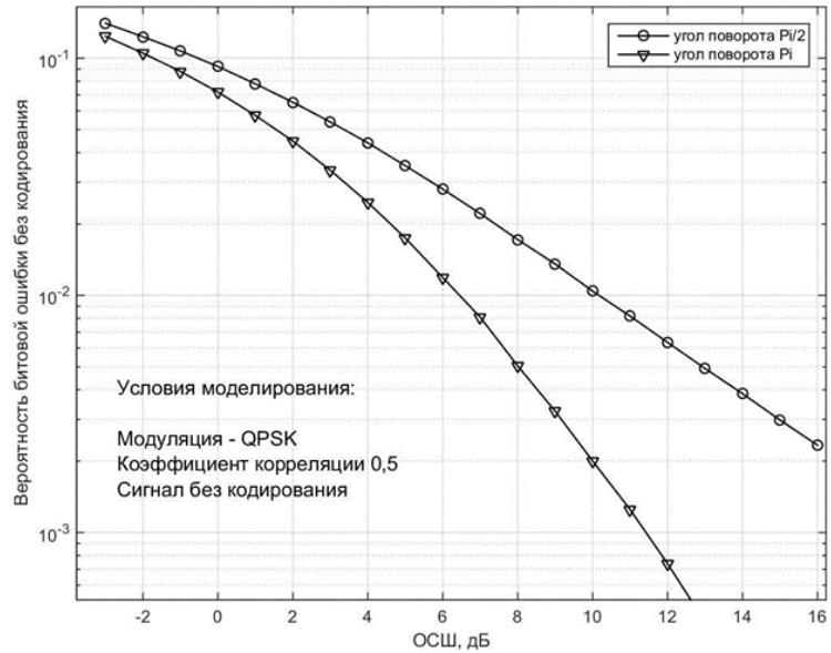
3.21 Сурет - Жүйелердің шуылға қарсы тұрақтылығын айналу бұрыштарында сигнал шоқжүлдізының айналуымен салыстыру  $\phi = \pi$  және  $\phi = \pi / 2$ .QPSK модуляциясы, кодтау жоқ, арна корреляцияланған.
