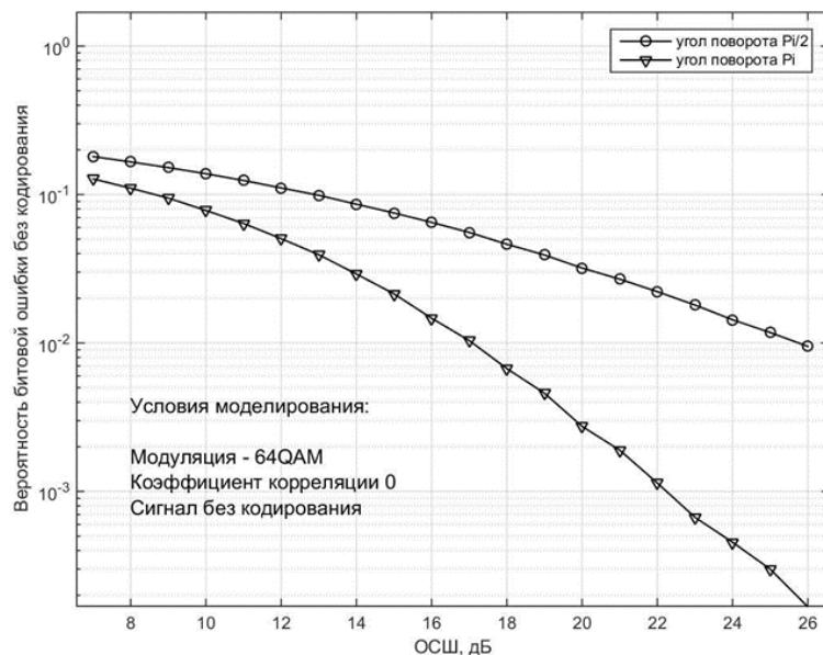
3.27 Сурет - Жүйелердің шуылға қарсы тұрақтылығын айналу бұрыштарында сигнал шоқжұлдызының айналуымен салыстыру  $\phi = \pi$  және  $\phi = \pi / 2$ . Модуляция 64-QAM, кодтау жок, арна түзетілмеген.
