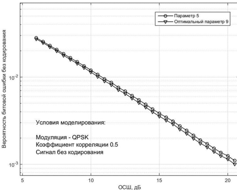
3.5 Сурет - Голден кодты әртүрлі параметрлермен қолданатын жүйелердің шылға төзімділігін салыстыру K. QPSK модуляциясы, кодтау жок, арна корреляцияланған
