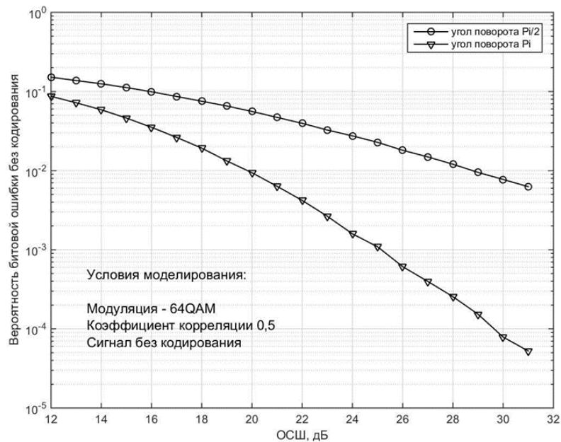
3.29 Сурет - Жүйелердің шуылға қарсы тұрақтылығын айналу бұрыштарында сигнал шоқжұлдызының айналуымен салыстыру  $\phi = \pi$  және  $\phi = \pi / 2.64$ -QAM модуляциясы, кодтау жоқ, арна корреляцияланған.
