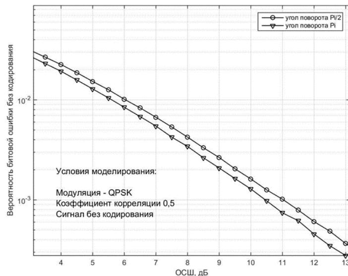
3.8 Сурет - Жүйелердің шуылға қарсы тұрақтылығын айналу бұрыштарында сигнал шоқжұлдызының айналуымен салыстыру  $\phi = \pi$  және  $\phi = \pi / 2$ .QPSK модуляциясы, кодтау жок, арна корреляцияланған.
