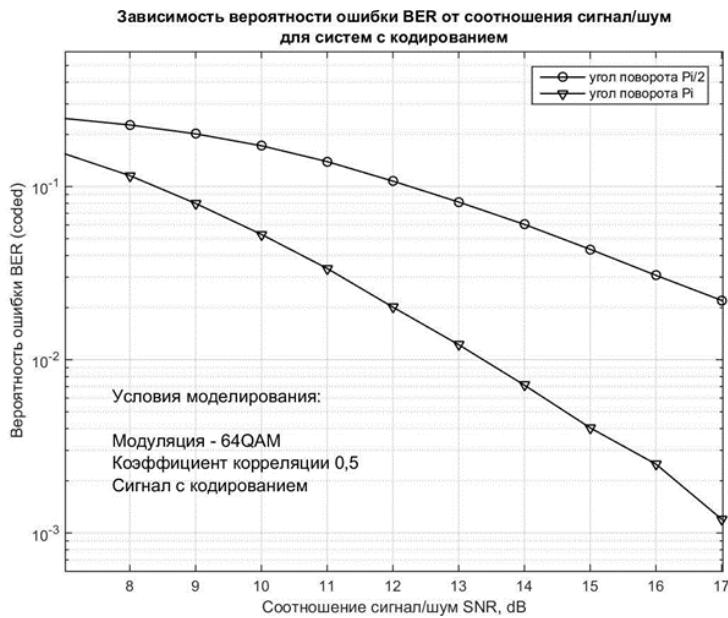
3.30 Сурет - Жүйелердің шуылға қарсы тұрақтылығын айналу бұрыштарында сигнал шоқжұлдызының айналуымен салыстыру  $\phi = \pi$  және  $\phi = \pi / 2.64$ -QAM модуляциясы, кодтау бар, арна корреляцияланған.
