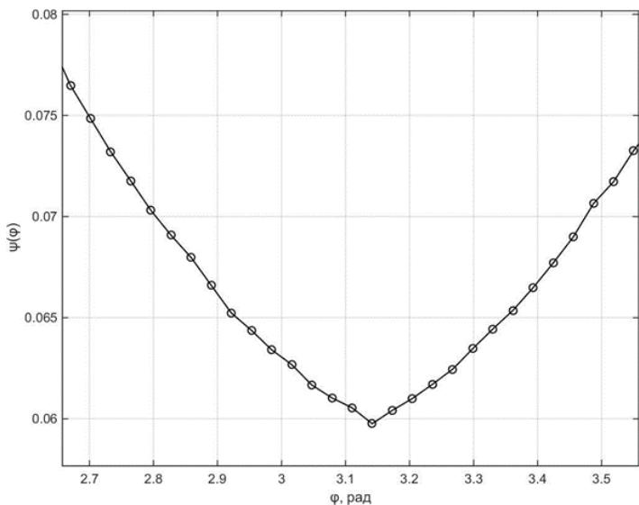
3.19 Сурет - Сигнал шоқжұлдызының бұрылышы бар Код үшін  $\psi(\phi)$  тәуелділігі. Арна корреляцияланған.
