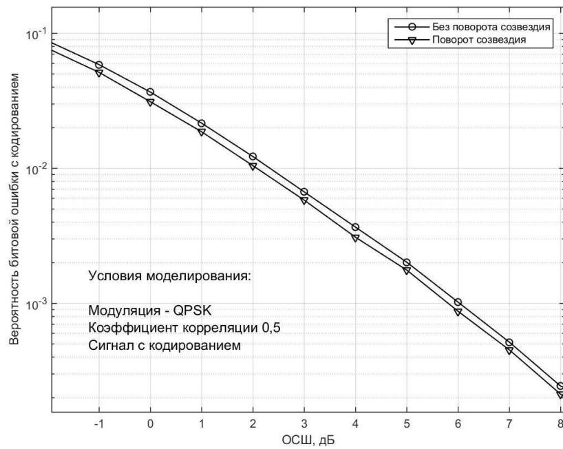
1.4 Сурет - Шоқжұлдыздың айналуы жоқ және шоқжұлдыздың айналуы бар жүйелердің шуға тәзімділігін салыстыру. QPSK модуляциясы, кодтау бар, арна корреляциясы.
