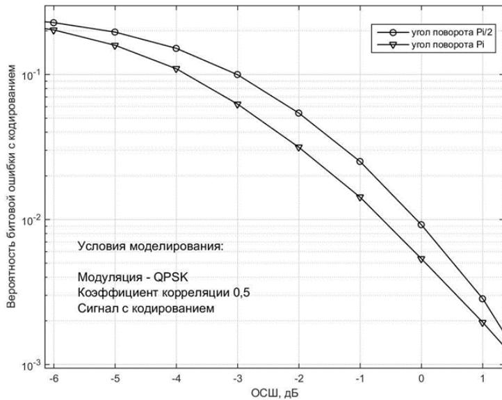
3.22 Сурет - Жүйелердің шуылға қарсы тұрақтылығын айналу бұрыштарында сигнал шоқжұлдызының айналуымен салыстыру  $\phi = \pi$  және  $\phi = \pi / 2$ .QPSK модуляциясы, кодтау бар, арна корреляцияланған
