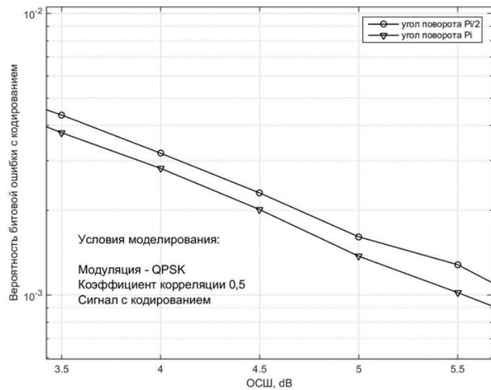
3.9 Сурет - Жүйелердің шуылға қарсы тұрақтылығын айналу бұрыштарында сигнал шоқжұлдызының айналуымен салыстыру  $\varphi = \pi$  және  $\varphi = \pi / 2$ .QPSK модуляциясы, кодтау бар, арна корреляцияланған.
