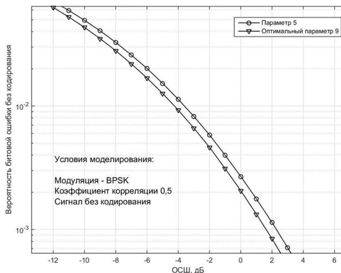
3.32 Сурет - Модификацияланған Голден кодын қолданатын жүйелердің
