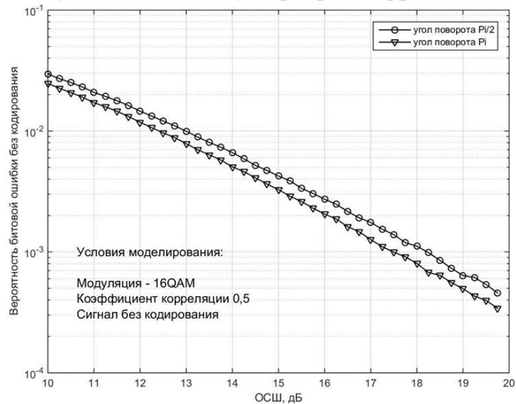
3.10 Сурет - Жүйелердің шуылға қарсы тұрақтылығын айналу бұрыштарында сигнал шоқжұлдызының айналуымен салыстыру  $\varphi = \pi$  және  $\varphi = \pi / 2$ .Модуляция 16-QAM, кодтау жоқ, арна корреляцияланған.
