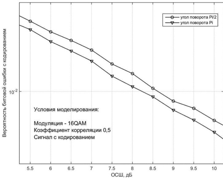
3.11 Сурет - Жүйелердің шуылға қарсы тұрақтылығын айналу бұрыштарында сигнал шоқжұлдызының айналуымен салыстыру  $\phi = \pi$  және  $\phi = \pi / 2$ . Модуляция 16-QAM, кодтау бар, арна корреляцияланған.
