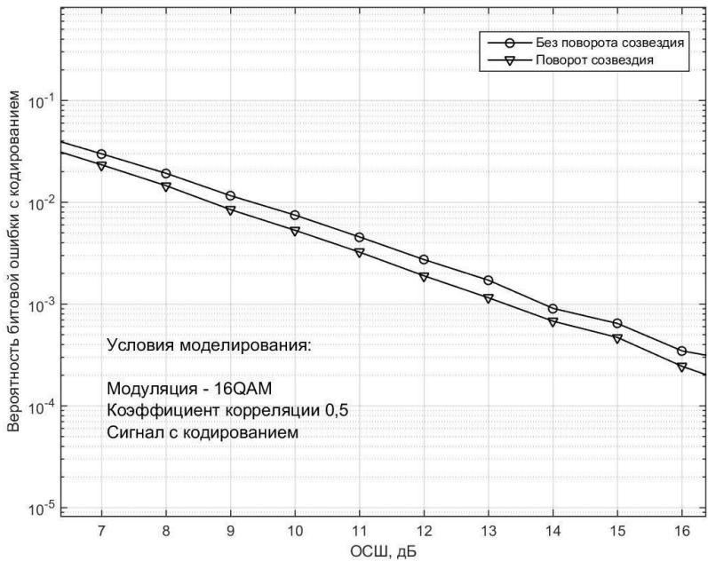
1.6 Сурет - Шоқжұлдыздың айналуы жок және шоқжұлдыздың айналуы бар жүйелердің шуға төзімділігін салыстыру. Модуляция 16-QAM, кодтау бар, арна корреляцияланған.
