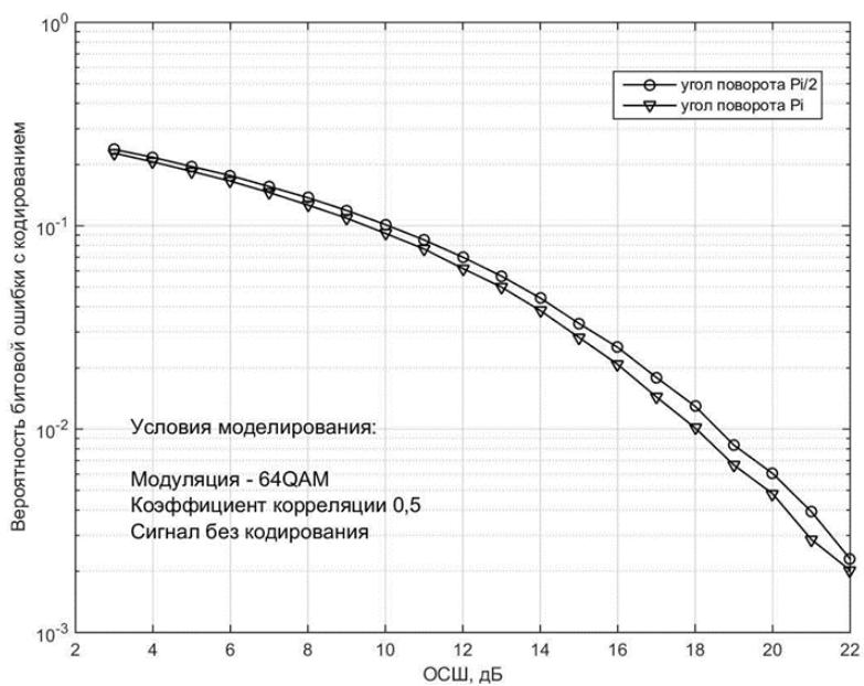
3.12 Сурет - Жүйелердің шуылға қарсы тұрақтылығын айналу бұрыштарында сигнал шоқжұлдызының айналуымен салыстыру  $\phi = \pi$  және  $\phi = \pi / 2.64$ -QAM модуляциясы, кодтау жоқ, арна корреляцияланған.
