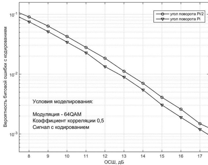
3.13 Сурет - Жүйелердің шуылға қарсы тұрақтылығын айналу бұрыштарында сигнал шоқжұлдызының айналуымен салыстыру  $\phi = \pi$  және  $\phi = \pi / 2.64$ -QAM модуляциясы, кодтау бар, арна корреляцияланған.
