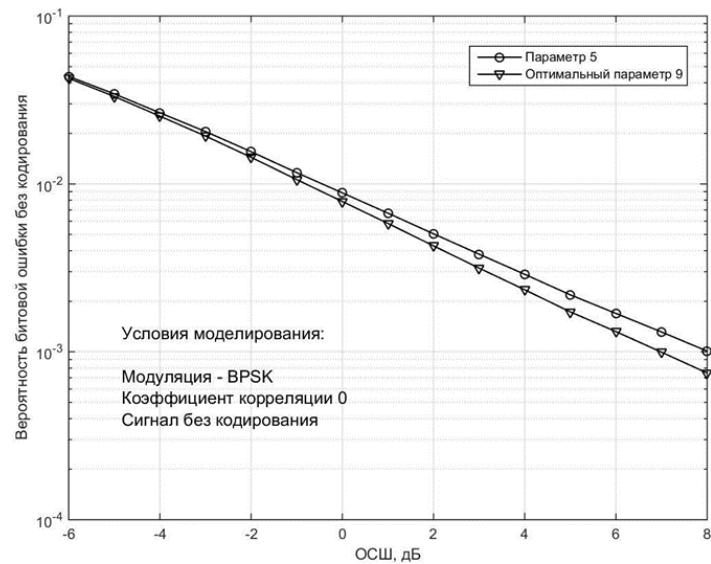
3.2 Сурет - Голден кодты әртүрлі параметрлермен қолданатын жүйелердің шуылға төзімділігін салыстыру K. BPSK модуляциясы, кодтау жоқ, арна түзетілмеген.
