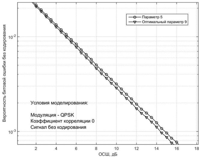
3.4 Сурет - Голден кодты әртүрлі параметрлермен қолданатын жүйелердің шылға төзімділігін салыстыру K. QPSK модуляциясы, кодтау жок, арна түзетілмеген.
