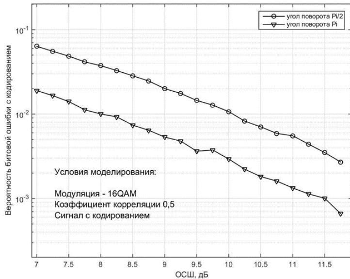
3.26 Сурет - Жүйелердің шуылға қарсы тұрақтылығын айналу бұрыштарында сигнал шоқжұлдызының айналуымен салыстыру  $\phi = \pi$  және  $\phi = \pi / 2$ . Модуляция 16-QAM, кодтау бар, арна корреляцияланған.
