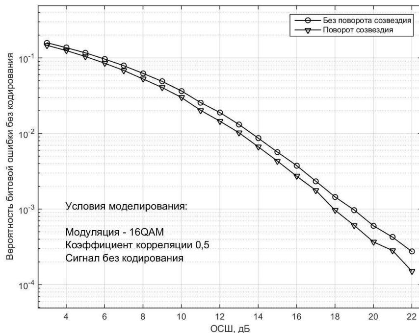
1.5 Сурет - Шоқжұлдыздың айналуы жоқ және шоқжұлдыздың айналуы бар жүйелердің шуға тәзімділігін салыстыру. Модуляция 16-QAM, кодтау жоқ, арна корреляциясы.
