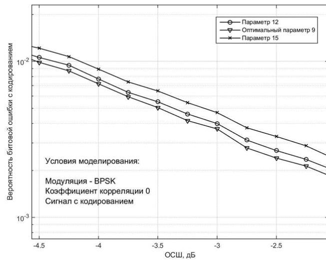
3.36 Сурет - Алтын кодты қолданатын жүйелердің шуылға қарсы иммунитетін әртүрлі параметрлермен салыстыру к. Bpsk модуляциясы, кодтау бар, арна түзетілмеген.
