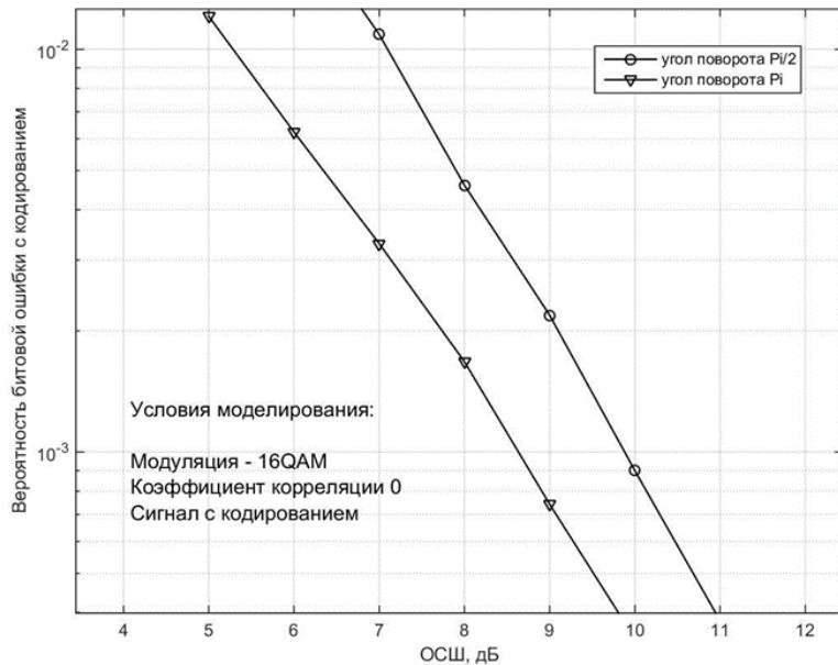
3.24 Сурет - Жүйелердің шуылға қарсы тұрақтылығын айналу бұрыштарында сигнал шоқжұлдызының айналуымен салыстыру  $\phi = \pi$  және  $\phi = \pi / 2$ . Модуляция 16-QAM, кодтау бар, арна түзетілмеген.
