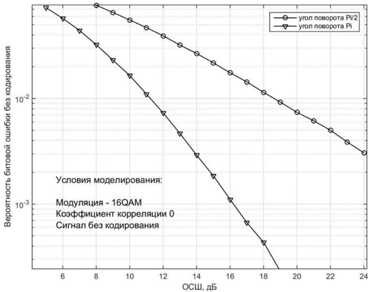
3.23 Сурет - Жүйелердің шуылға қарсы тұрақтылығын айналу бұрыштарында сигнал шоқжұлдызының айналуымен салыстыру  $\phi = \pi$  және  $\phi = \pi / 2$ .Модуляция 16-QAM, кодтау жоқ, арна түзетілмеген.
