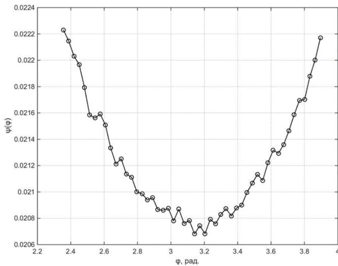
3.6 Сурет - Сигнал шоқжұлдызының бұрылышы бар Код үшін  $\psi(\phi)$  тәуелділігі . Арна корреляцияланған.
