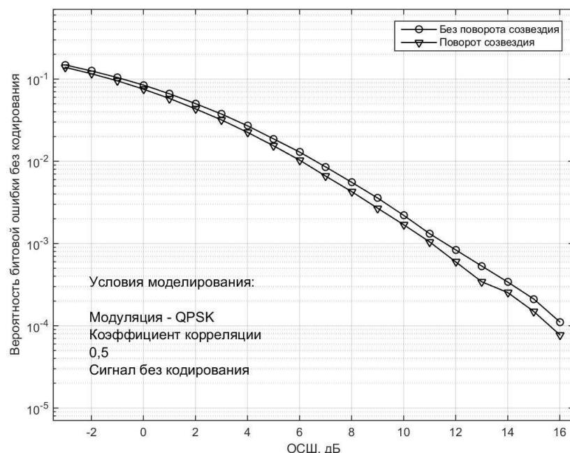
1.3 Сурет - Шоқжұлдыздың айналуы жоқ және шоқжұлдыздың айналуы бар жүйелердің шуға төзімділігін салыстыру. QPSK модуляциясы, кодтаусыз, арна корреляциясы.
