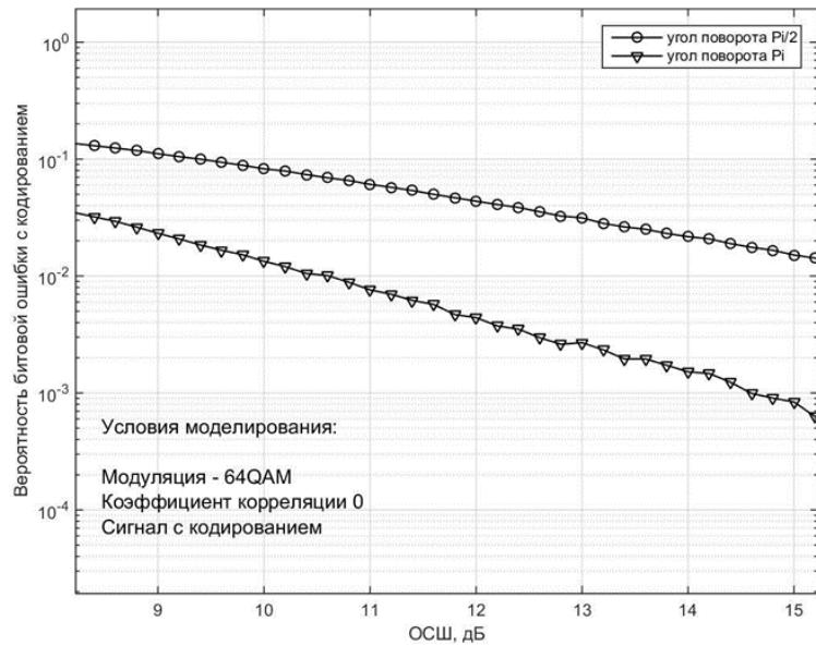
3.28 Сурет - Жүйелердің шуылға қарсы тұрақтылығын айналу бұрыштарында сигнал шоқжұлдызының айналуымен салыстыру  $\phi = \pi$  және  $\phi = \pi / 2$ . Модуляция 64-QAM, кодтау бар, арна түзетілмеген.
