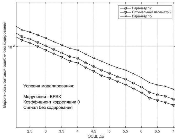
3.35 Сурет - Алтын кодты қолданатын жүйелердің шуылға қарсы иммунитетін әртүрлі параметрлермен салыстыру к. BPSK модуляциясы, кодтау жоқ, арна түзетілмеген.
