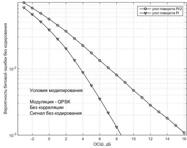
3.20 Сурет - Жүйелердің шуылға қарсы тұрақтылығын айналу бұрыштарында сигнал шоқжүлдізының айналуымен салыстыру  $\phi = \pi$  және  $\phi = \pi / 2$ .QPSK модуляциясы, кодтау жоқ, арна түзетілмеген.
