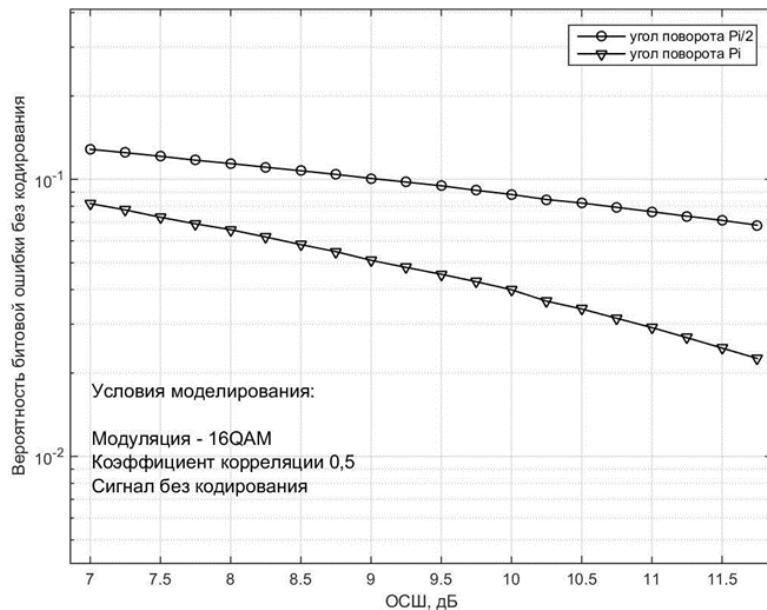
3.25 Сурет - Жүйелердің шуылға қарсы тұрақтылығын айналу бұрыштарында сигнал шоқжұлдызының айналуымен салыстыру  $\phi = \pi$  және  $\phi = \pi / 2$ . Модуляция 16-QAM, кодтау жоқ, арна корреляцияланған.
